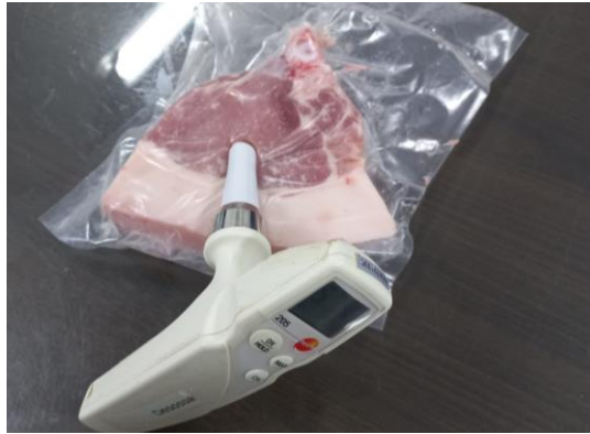
Figura 6. Amostras de Longissimus dorsi obtida entre a 10 a e a 11 a vértebra e peagâmetro utilizado na determinação do pH.
