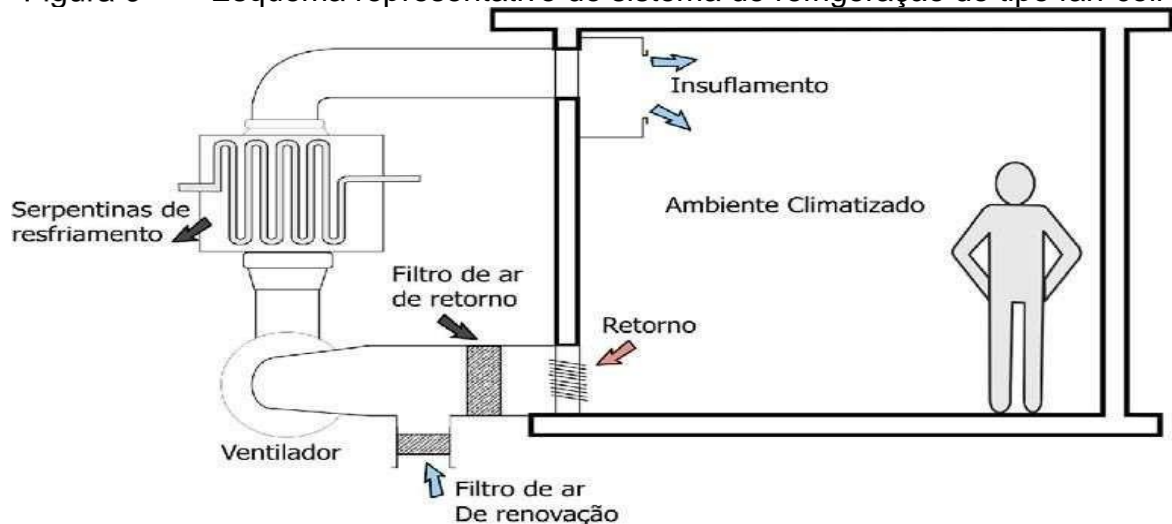
Figura 9 - Esquema representativo do sistema de refrigeração do tipo fan-coil
