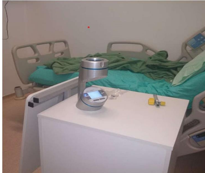
Figura 18 - Registro da coleta da amostra de ar em um dos leitos de precaução aérea
