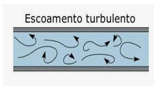
Figura 13 - Esquema Ilustrativo de um fluxo turbulento
