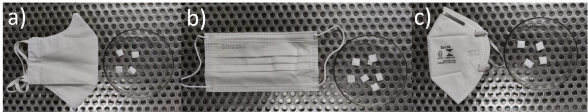
Figura 9 - Os três tipos de máscaras e os pedaços (amostras) cortados: a) Máscara de tecido (tricoline 100% algodão), b) Máscara cirúrgica e c) Respirador N95
