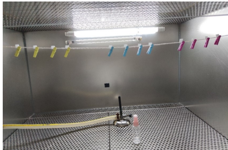
Figura 10 - Amostras dispostas na capela de fluxo laminar para realização da contaminação
