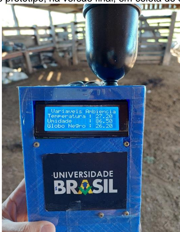
Figura 9 - Caixa do protótipo, na versão final, em coleta de dados experimentais
