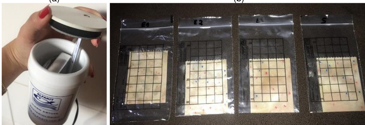
Figura 22 - Micro estufa microbiológica (a), contagem nas cartelas Colipaper ® (b)
