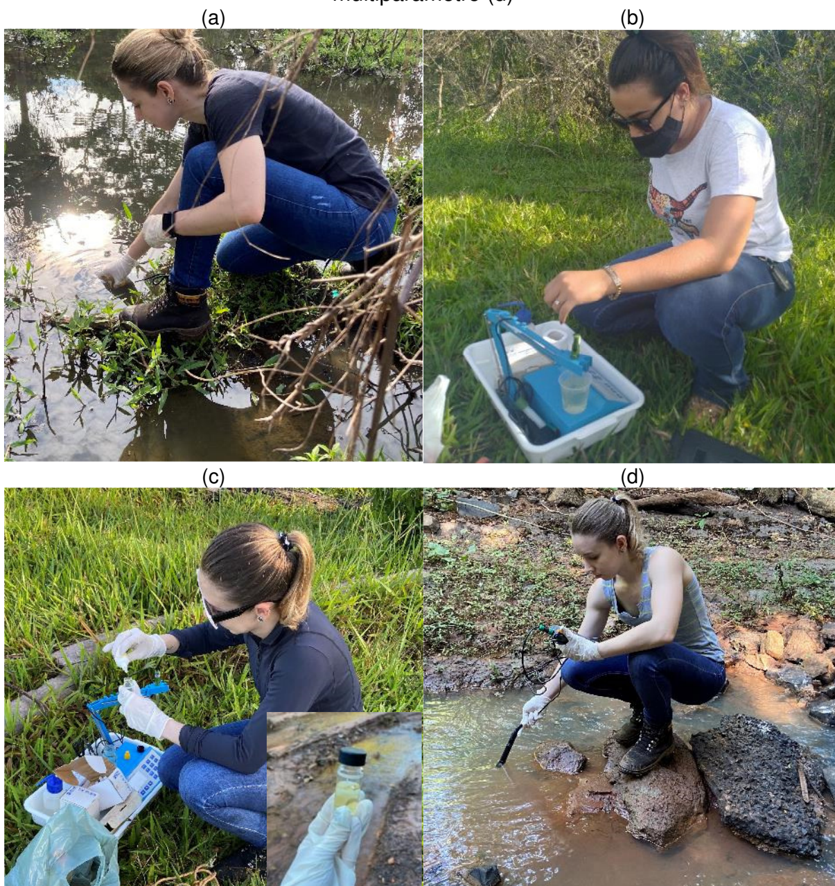
Figura 19 - Coleta das amostras in situ (a), análise com o fotômetro multiparâmetro (b), utilização dos reagentes de \text{NH}_3 e \text{NH}_4^+ (c) e análise com o medidor multiparâmetro (d)
