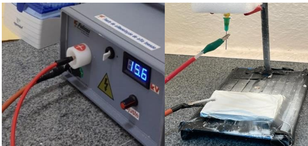
Figura 7 – Sistema de Eletrofiação com montagem da seringa na vertical (fluxo por gravidade), nos parâmetros de Salles et al., 2017
