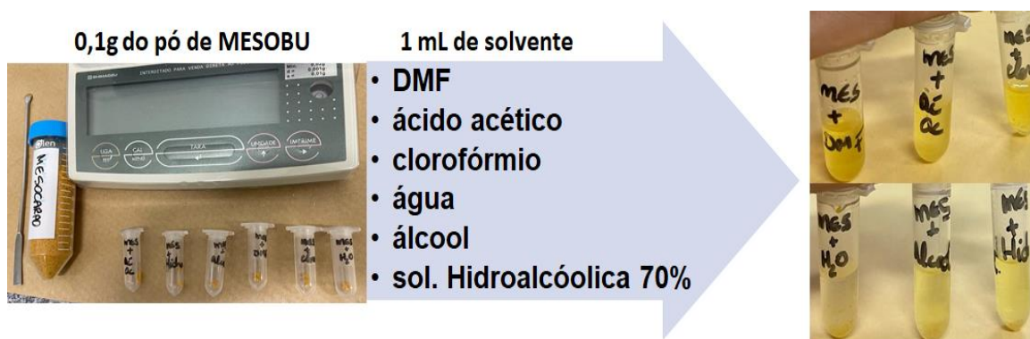
Figura 5 – Esquematização do teste de solubilidade
