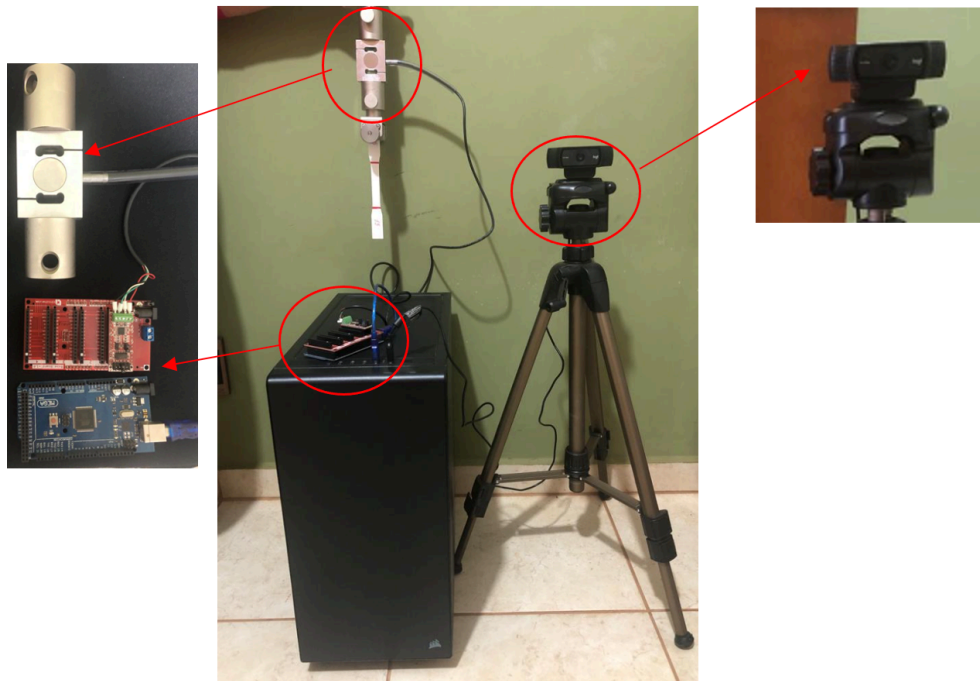
Figura 25. Montagem do hardware para vídeo extensômetro.
