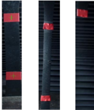
Figura 62. Etapas do vídeo no rompimento dos corpos de prova em borracha.
