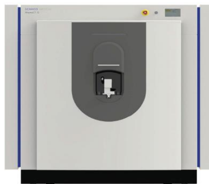
Figura 1 – XtremeCT II Scanco Medical – Aparelho clínico de microtomografia por raios-X (HR-pQCT).
