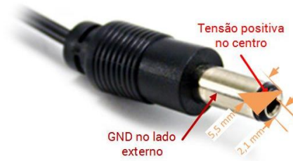
Figura 23: Imagem do plugue de 2,1mm necessário para conexão com Arduino.
