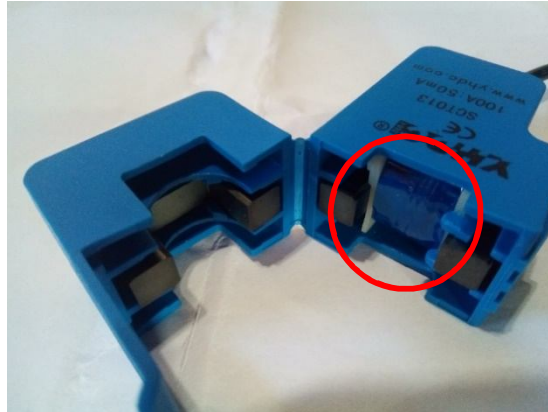
Figura 43: Bobina do sensor de corrente não invasivo.
