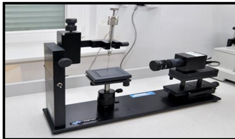
Figura 5- Equipamento utilizado para caracterização das membranas. Goniômetro da marca KSV Instruments modelo CAM 200
