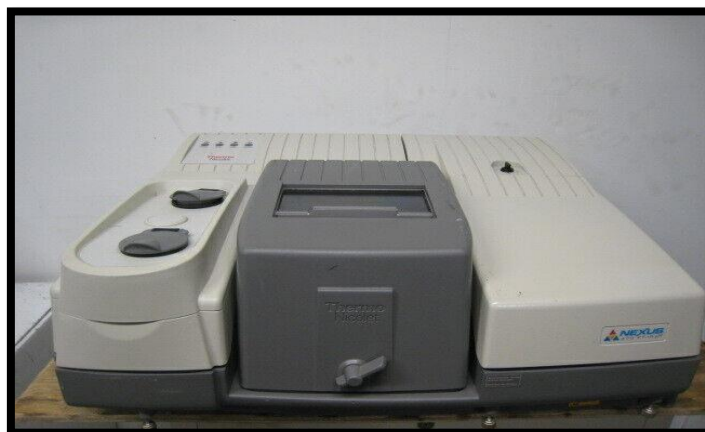
Figura 4- Equipamento utilizado para caracterização das membranas. Espectrômetro de infravermelho por transformada de Fourier
