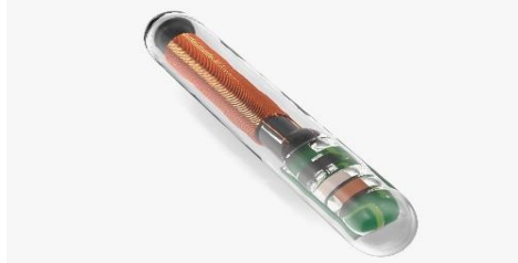
Figura 2 – TAG RFID para aplicação em animais sob a pele
