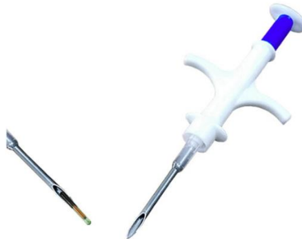
Figura 3 – Aplicador utilizado para implantar TAG RFID sob a pele do animal
