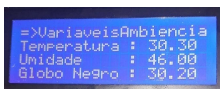
Figura 17 - Display com as variáveis ambientais coletadas, índices calculados, classificação do estresse térmico e tomada de decisão
