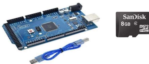
Figura 8 - Ilustrativa da placa Arduino Mega 2560 R3, com cabo Atmega2560 e cartão de memória de 8GB
