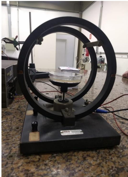
Figura 4 - Bobina de Helmholtz com porta substrato de alumínio disposto em seu eixo central
