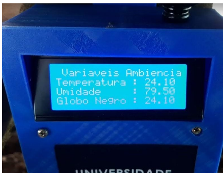
Figura 14 - Imagem do display do protótipo desenvolvido, realizando a medição da temperatura, umidade e temperatura do globo negro.
