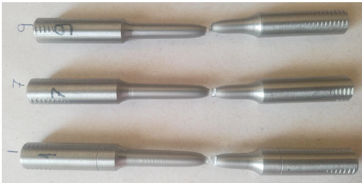
Figura 50 – Ensaio de tração grupo B, Inox 304, velocidade de ensaio 15mm/min.
