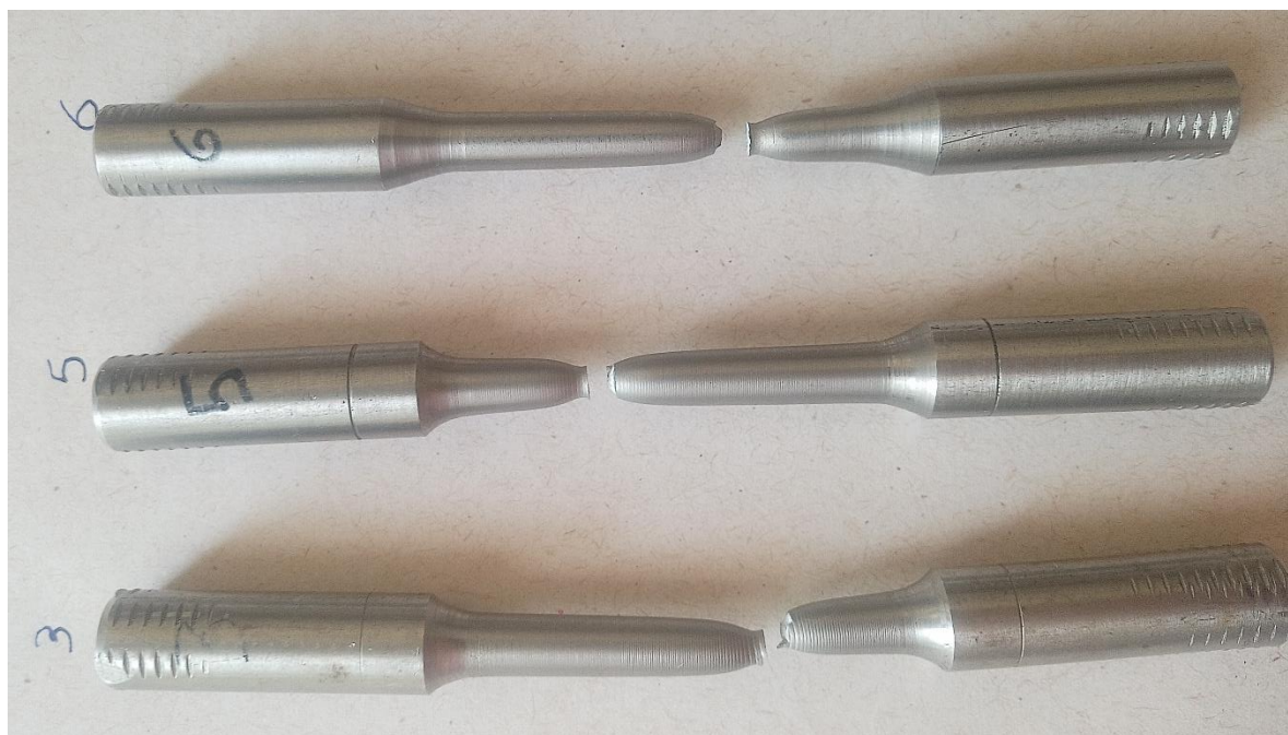
Figura 48 – Ensaio de tração grupo A, Inox 304, velocidade de ensaio 7mm/min.
