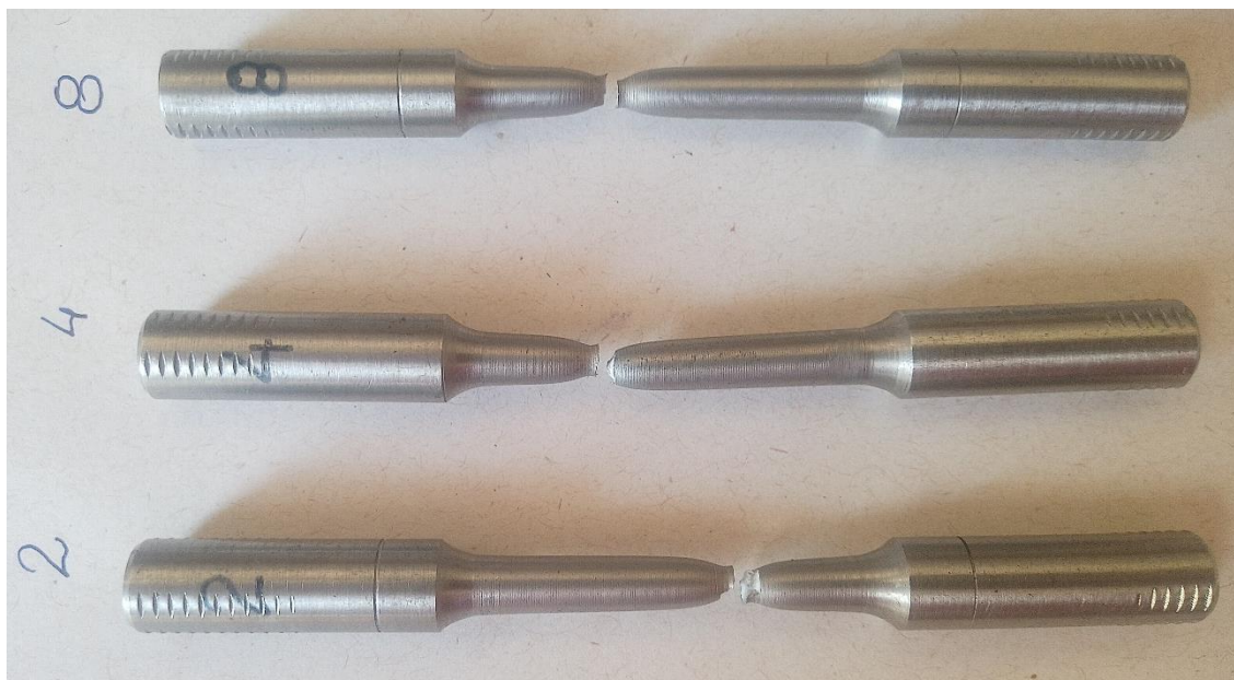
Figura 52 – Ensaio de tração grupo B, Inox 304, velocidade de ensaio 22mm/min.
