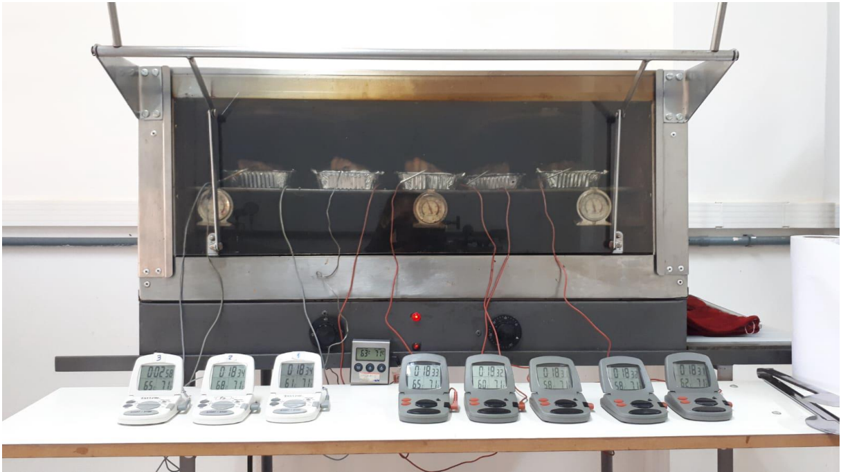
Figura 9: Amostras assadas para a análise de perdas totais por cocção e maciez objetiva.
