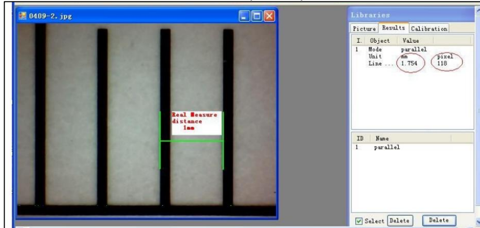
Figura 10 - Exemplo de tela do programa Cooling Tech® para identificação da escala número de pixels: \mu\text{m}
