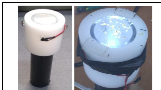
Figura 11 - Cápsula de fixação do microscópio, em posição invertida, para teste de bancada
