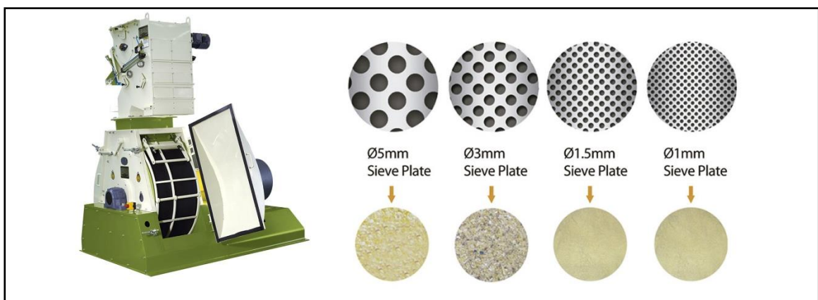
Figura 2 - Modelo de moinho martelo e suas diferentes peneiras (5; 3; 1,5 e 1 mm, respectivamente)
