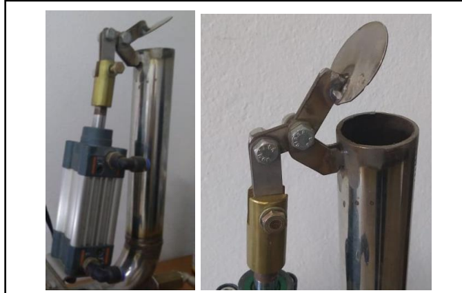
Figura 9 - Cilindro pneumático instalado junto ao conjunto esfíncter
