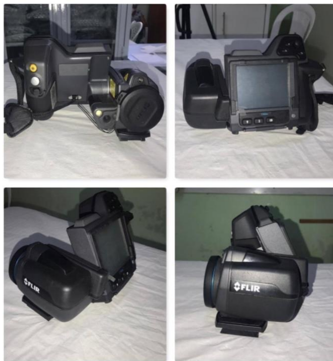
Figura 3- Câmera usada para captação das imagens térmicas infravermelhas: FLIR, modelo T430SC
