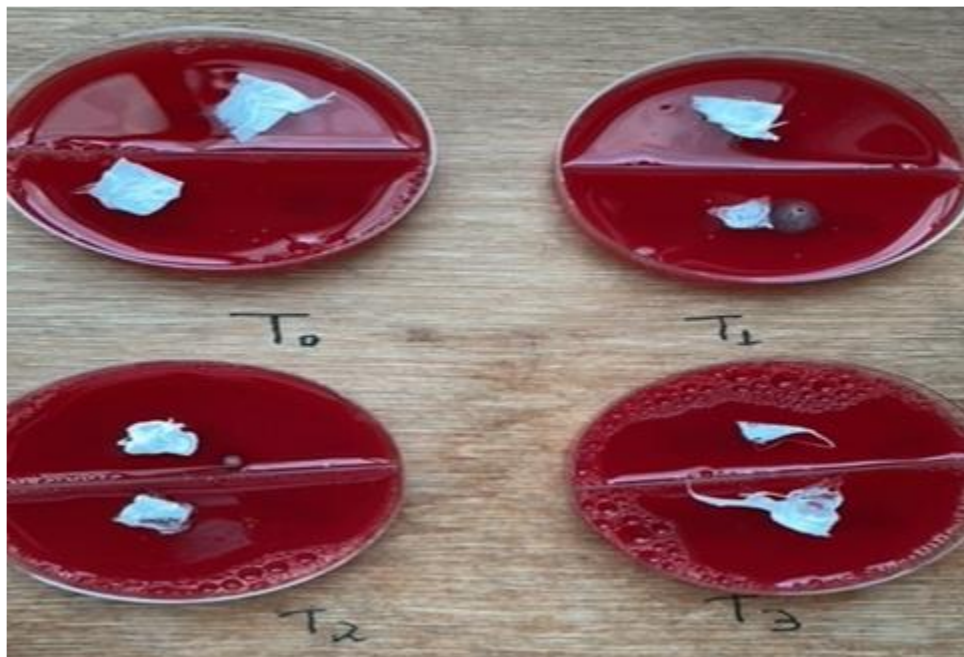
Figura 9 – Prova de esterilização das mantas produzidas
