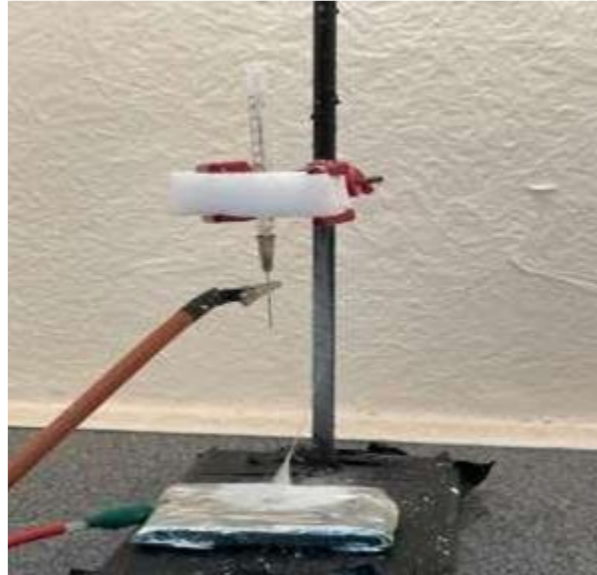
Figura 5 – Sistema de eletrofição com coletor de recepção da manta eletrofiada
