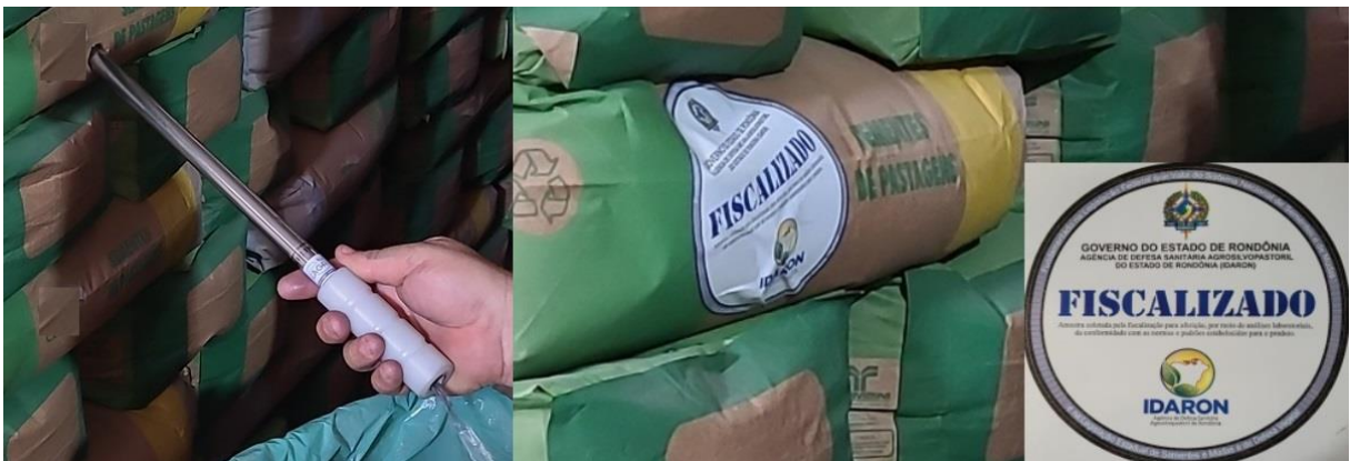
Figura 7 - Coleta de sementes de pastagens com calador “nobbe”
