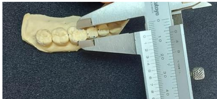
Figura 13: Mensuração do modelo de gesso com paquímetro
